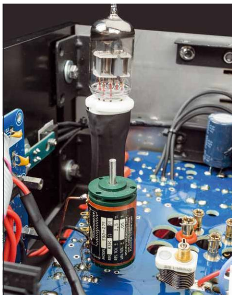
Dieses Trimpotenzimeter ist ein hoch belastbares und sehr edles Modell
